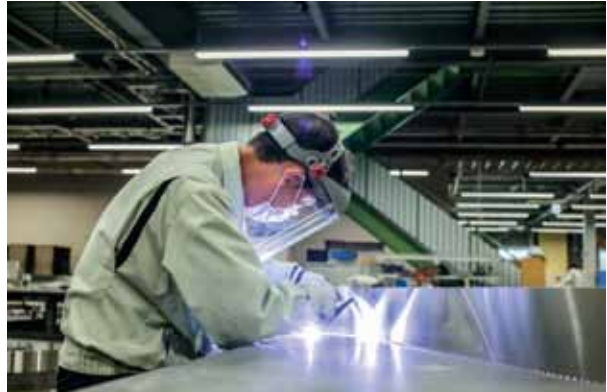
箱文字の溶接の様子
