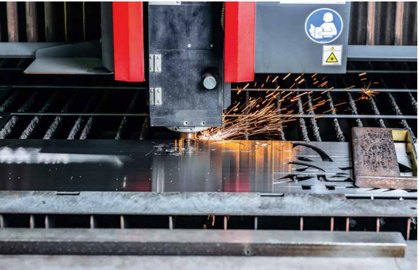
レーザーで金属厚板から文字を切り抜く
