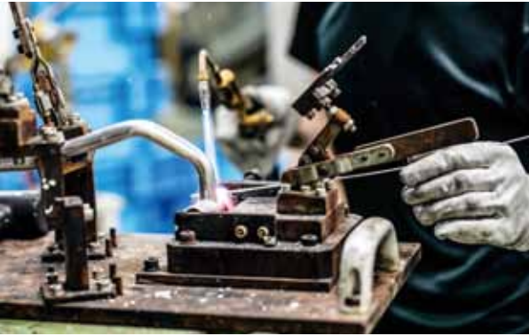
アルミニウム製配管の独自のロウ付け加工
