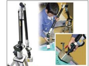
ベクトロン (可搬式三次元計測器) を用いての品質保証、管理を致します
