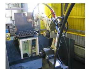
溶接ロボット
