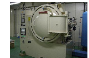
焼入れ温度1300℃まで対応できる加圧冷却式真空熱処理炉
