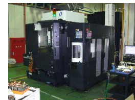
高精度マシニングセンター V22+ワークチェンジャー (MAKINO)
