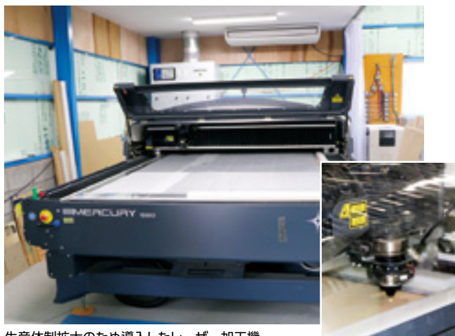
生産体制拡大のため導入したレーザー加工機
