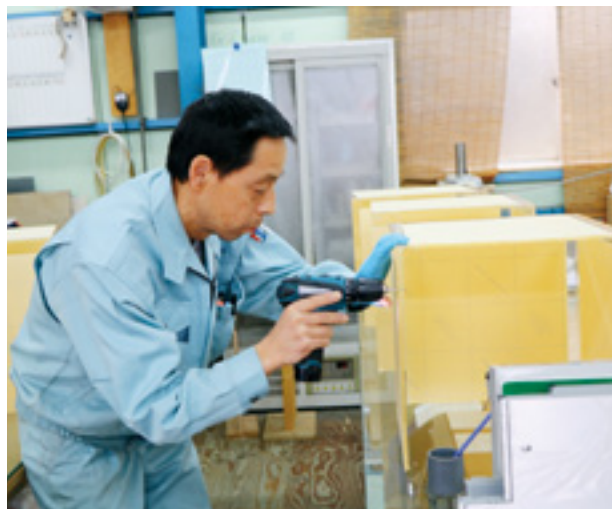
ドリルを使った接着のほか、曲げ、溶接など多彩な加工を施す
