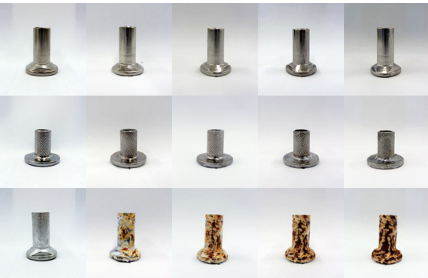
塩水噴霧試験でネオメッキの耐食性はステンレスに迫ることを証明（上；ステンレス、中；ネオメッキ、下；溶融亜鉛メッキ）
