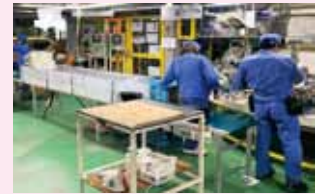
After 部品箱や予熱器をコンパクトにインライン化
