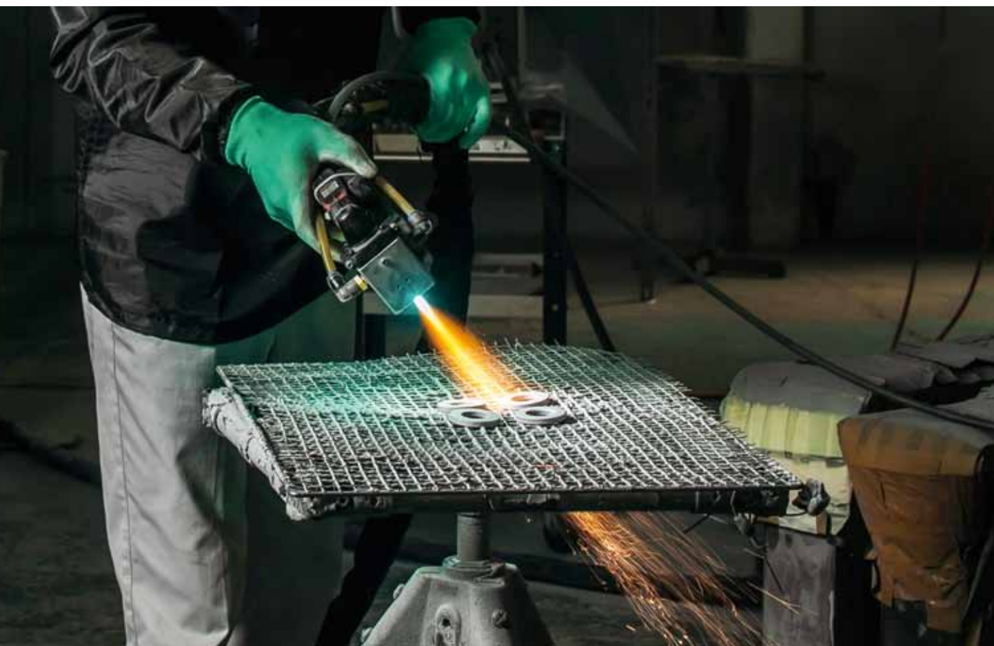
摂氏8000~10000度の高温で溶射材料を溶融、吹き付ける
