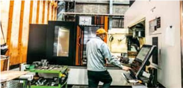
大型のマシニングセンターでの高精度の精密機械加工
