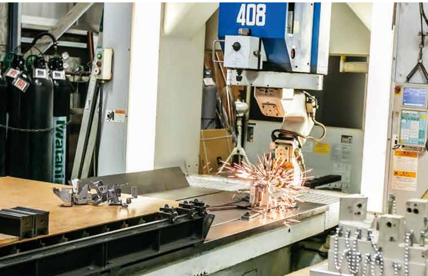
レーザー加工機でプレス部品を加工
