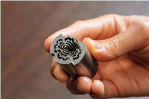
加工ノウハウが凝縮したサンプルの加工精度は3マイクロメートル
