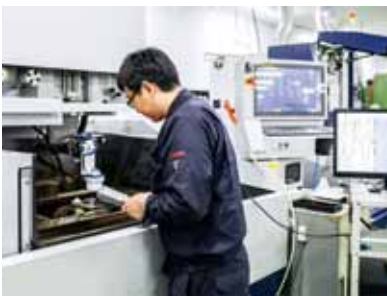
機上測定機によって加工対象の脱着が不要になる
