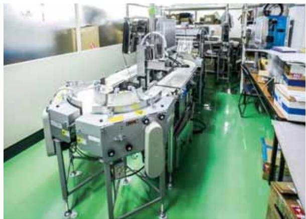
画像処理技術を用いた食品関連ラベル検査装置
