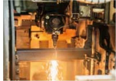
ファブリギア加工機による切断の様子
