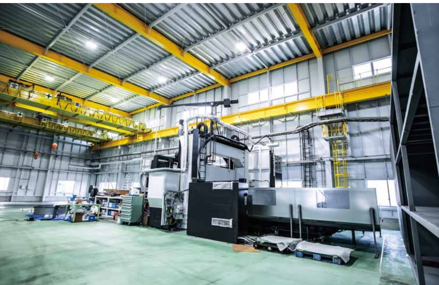
新工場に導入した最新の門型5面加工機
