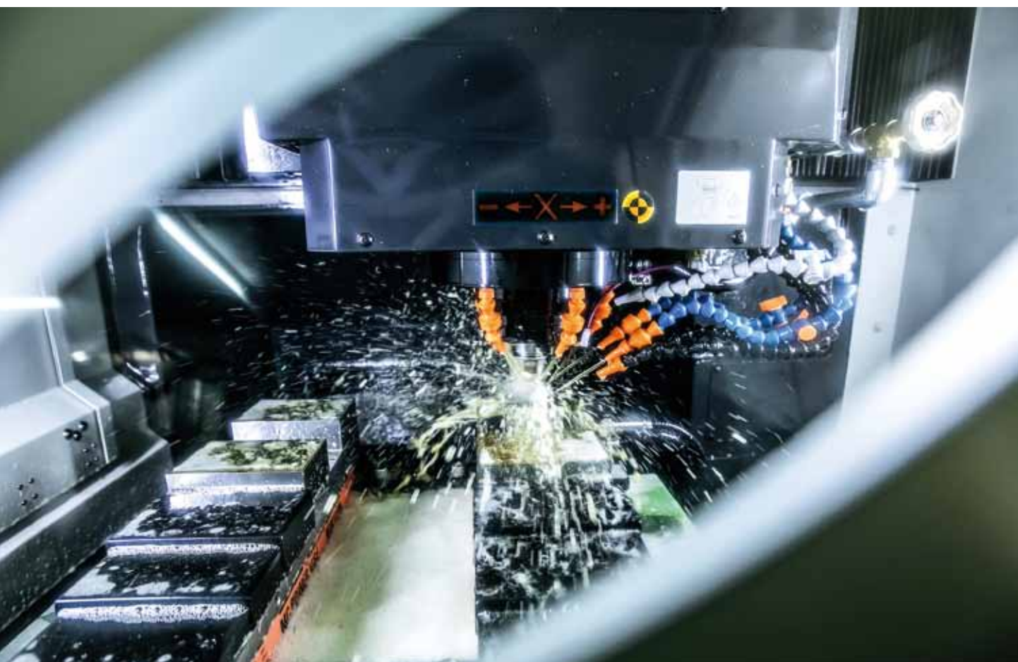
マシニングセンタによる金型部品の最終仕上げ加工
