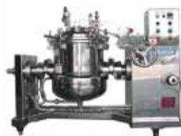
FACTory Classroomに寄贈した機械と同じ機能を持つ機械「加圧・真空式攪拌釜」
