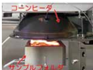
燃焼性(発熱性)試験の様子
