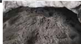
カバーを取り外した状態の電池(左)と回収されたブラックマス(電池を乾燥・破碎・選別して回収されるリチウム、コバルト、ニッケルの濃縮粉体)(右)
