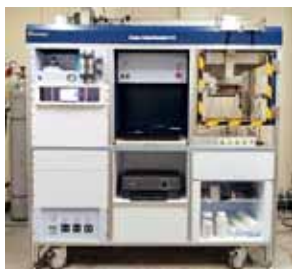
燃焼性(発熱性)試験の様子
