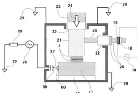
1 部材 16,22,25 絶縁体 17 超音波接合する部材の受け治具, 18 超音波振動子, 19 中周波の交流の電圧を出力する電源, 20 ホーン, 21 超音波接合する部材への超音波を印加する治具, 23 荷重をかける治具, 26 高周波電源, 27 コンデンサ, 28 短絡防止のための抵抗, 29 GND, 59 ケーブル 60 ねじ止
