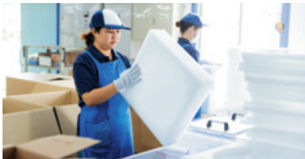
自動車の緩衝材をカットする
