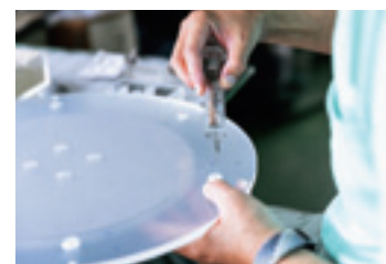
樹脂製品の接着作業
