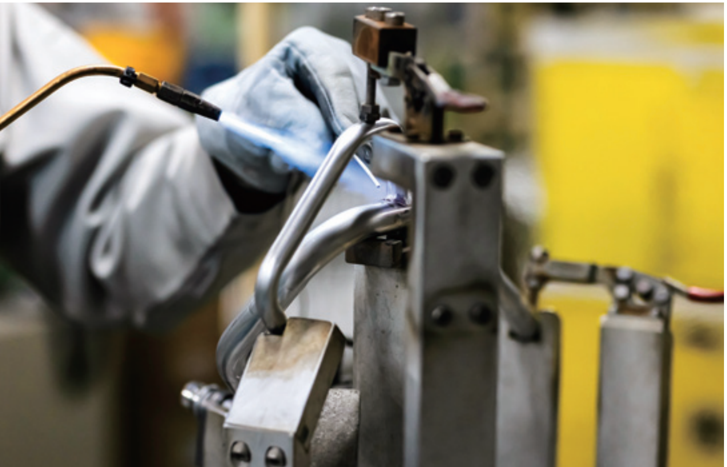
ロウ付けで次々と自動車部品を仕上げている
