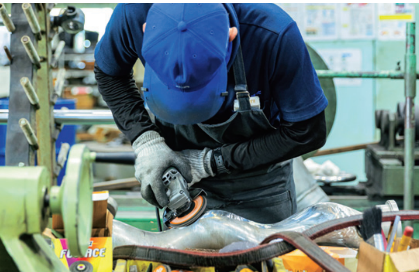
メッキ処理後の金属部品を手作業で仕上げていく
