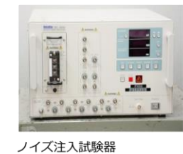
ノイズ注入試験器 ノイズ幅: 50,100,200,250,400ms ±10%の組合わせ および短接接続に 10ns±3ns 出力電圧: 0.01~4.00kV±10% 極性: 正または負 立ち上がり時間: 1ns以下
