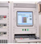
BCI試験設備 100kHz~1GHz Max CW Input 100W
