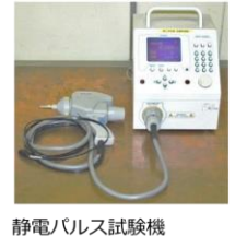
静電/パルス試験機 出力電圧: 0.2kV~30kV 極性: 正または負 放電モード: 気中放電および接触放電
