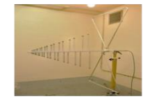
3x3m 簡易電波暗室 30MHz~1GHz: 60dB
