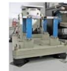
振動試験機装置 振動波形: 正弦波 / ランダム波 振動方向: 垂直、水平、斜軸方向のみ 振動周波数範囲: 垂直加振: 5 Hz ~ 5000 Hz 水平加振: 5 Hz ~ 500 Hz 最大変位量: 15 mm p-p 最大加振力: 正弦波: 0.98 kN ランダム波: 0.69 kNrms 最大搭載質量: 垂直加振: 30 kg 水平加振: 10 kg
