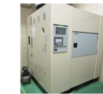
冷熱衝撃試験装置 温度範囲: 低温: -70℃ ~ 0℃ 高温: 60℃ ~ 200℃ 温度変移時間: 5分以内
