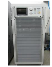
大容量交流電源 モデル: 61512 出力容量: 18kVA 電圧レンジ: 0~150V/0~300V/Auto 周波数範囲: DC, 15Hz~1500Hz
