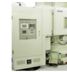
温度上昇試験機 測定可能温度: -200℃~+2000℃ 測定可能CH数: 30CH 記録間隔: 100ms ~ 1h
