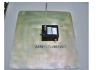
LISN (line impedance stabilization network) 電源インピーダンス安定化回路
