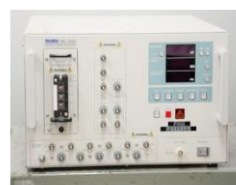
ノイズ注入試験器 パルス幅 50,100,200,250,400ns ±10%の組合わせ および最短接続に 10ns±3ns 出力電圧 0.01~4.00kV±10% 極性 正または負 立ち上がり時間 1ns以下
