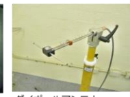
ダイポールアンテナ 470MHz~1700MHz
