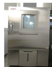
恒温恒湿槽 温度範囲 : -70~+150℃ 湿度範囲 : 20~98%RH 湿度変化時間 : -70~150℃ : 50分以内 +20~70℃ : 75分以内 槽内寸法 : W1000 x H1000 x D800 mm
