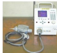
静電ノイズ試験機 出力電圧 0.2kV~30kV 極性 正または負 放電モード 気中放電および接触放電
