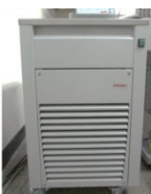
チラー 冷媒温度範囲 : -60~+100℃ 最大流量 : 25L/min 冷媒 : LLC対応
