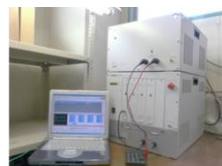
ISO サージ試験機 ISO7673-2:2004規格に対応 Pulse 1, 3a/3b, 5a/5b
