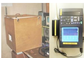
温度上昇試験機 測定可能温度 -200℃~+2000℃ 測定可能CH数 30CH 記録間隔 100ms ~ 1h
