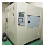
冷熱衝撃試験装置 温度範囲 低温 : -70℃ ~ 0℃ 高温 : 60℃ ~ 200℃ 温度変移時間 : 5分以内
