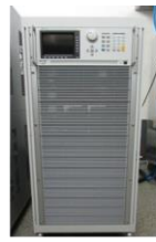
大容量交流電源 モデル : 61512 出力容量 : 18kVA 電圧レンジ : 0~150V/0~300V/Auto 周波数範囲 : DC, 15Hz~1500Hz
