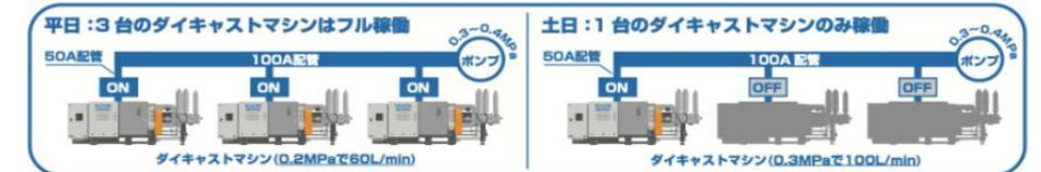
技術内容 フローコントローラを使用した冷却水の自動制御システム
