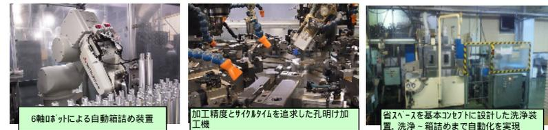
6軸ロボットによる自動箱詰め装置
