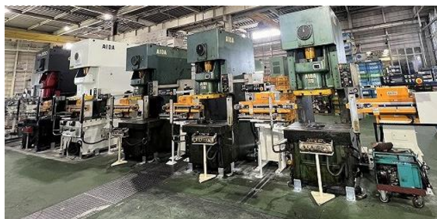
・RHNロボットライン (200t×2、110T×3工程)
