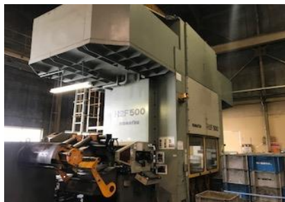
八雲設備コマツ500tサーボプレス
