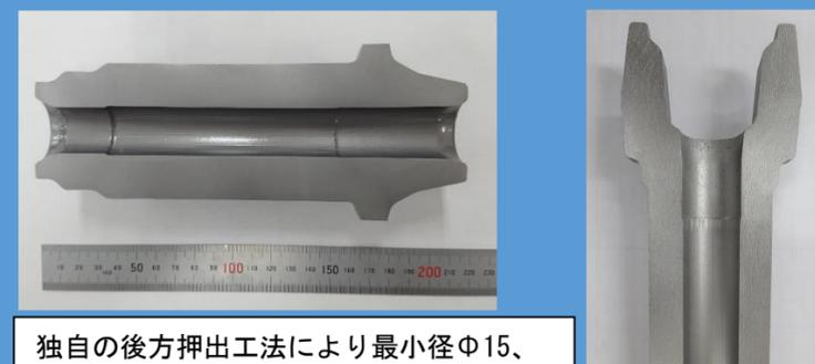
独自の後方押出工法により最小径φ15、
