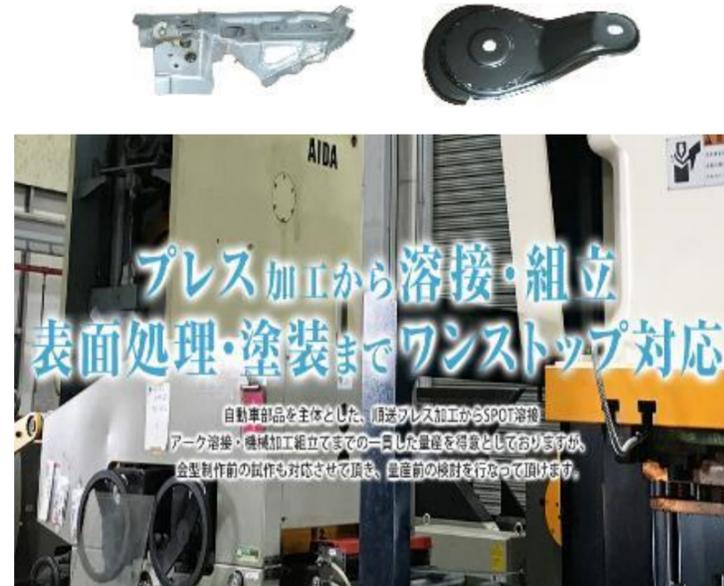
自動車部品を主体とした、精密プレス加工からSPOT溶接、アーク溶接・機械加工組立までの一貫した量産を得意としており、金型製作前の試作も対応させて頂き、生産前の検封を行なっております。
