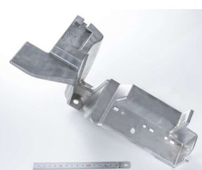
ブラケット 鉄製比: (▲730g(▲60%)) 複雑構造の一体成型・薄肉化により 重量1/3、加工工程削減を達成!
