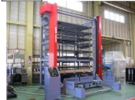
設計から組立まで一貫して制作した 自社製品(スタッカー)
