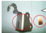
プレス加工品と銅箔シート切断加工品
