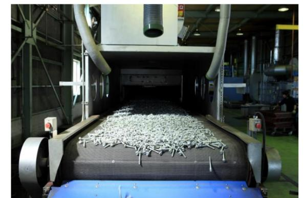
※ジオメット液へ製品を浸漬・振切りし、その後コンペアで焼付け、乾燥し、皮膜形成します。
