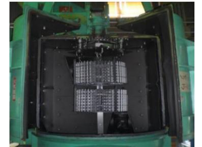
※ショットブラスト～製品にあわせて、製品を研磨0.2mmの鉄球で研磨し、下地を作ります。
