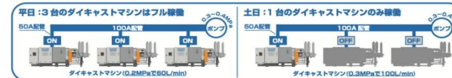
技術内容 フローコントローラを使用した冷却水の自動制御システム
