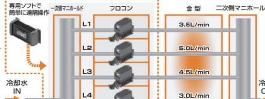
各系統の供給圧力が変動しても、設定流量に自動制御する。
