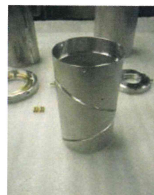
アルミ管にカム曲線溝加工
