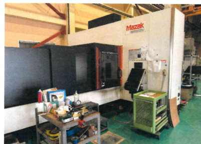
ヤマザキマザック マシニングセンター 1台 型式:FJV 5Face-60/120 簡易五面機能付
