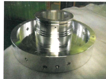
直径280mmの旋盤加工品 横穴は、横型マシニング加工)材質:A5052
