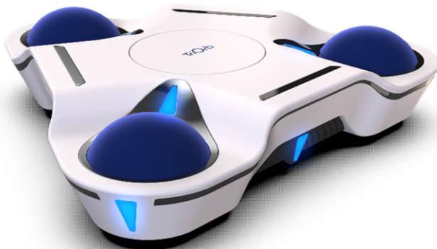
球を駆動輪とした移動プラットフォーム
