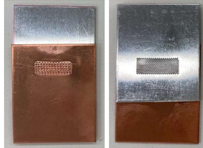
独自の接合技術で、接合時の加圧力と振幅が抑えられ、部材ダメージが少ない(変形なし)
