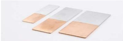
EV車載用等の大容量電池のモジュールには異種金属接合部品が必要であるが、異種金属クラッド材は価格も高く、材料ロスも大きい異種金属(銅とアルミ)の接合を超音波接合する事で部品価格を大幅に低減する
