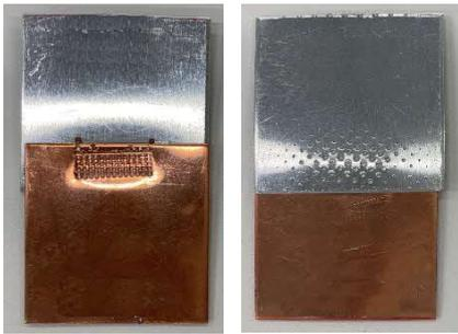
異種金属の接合には大きい加圧力と振幅が必要で、部材ダメージが極めて大きい(変形)
